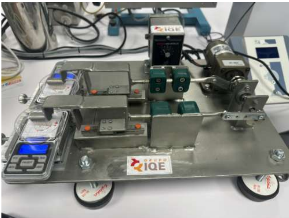
Figura 16.- Simulador experimental de cepillado en el que se han llevado a cabo las diferentes pruebas de evaluación de abrasividad de las diferentes sílices precipitadas.
