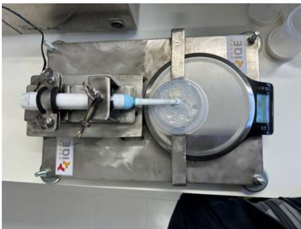
Figura 15.- Primer prototipo del simulador experimental de cepillado.
