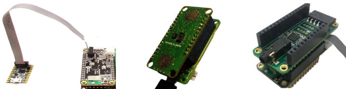
Figura 21. Vistas de la plataforma de desarrollo junto al programador, del escudo desarrollado y del escudo para la medida de electrocardiograma, respectivamente
