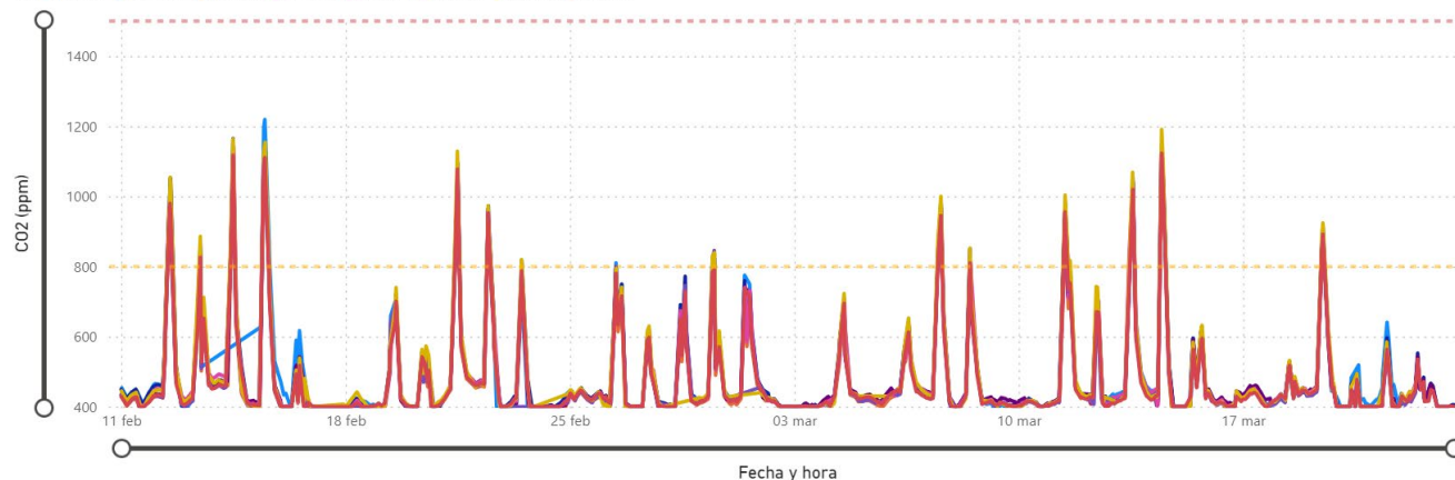
Figura 8. Evolución del CO 2 de 8 de sensores MICA y MICA plus en la misma ubicación. Periodo del 11/02 al 23/03.
