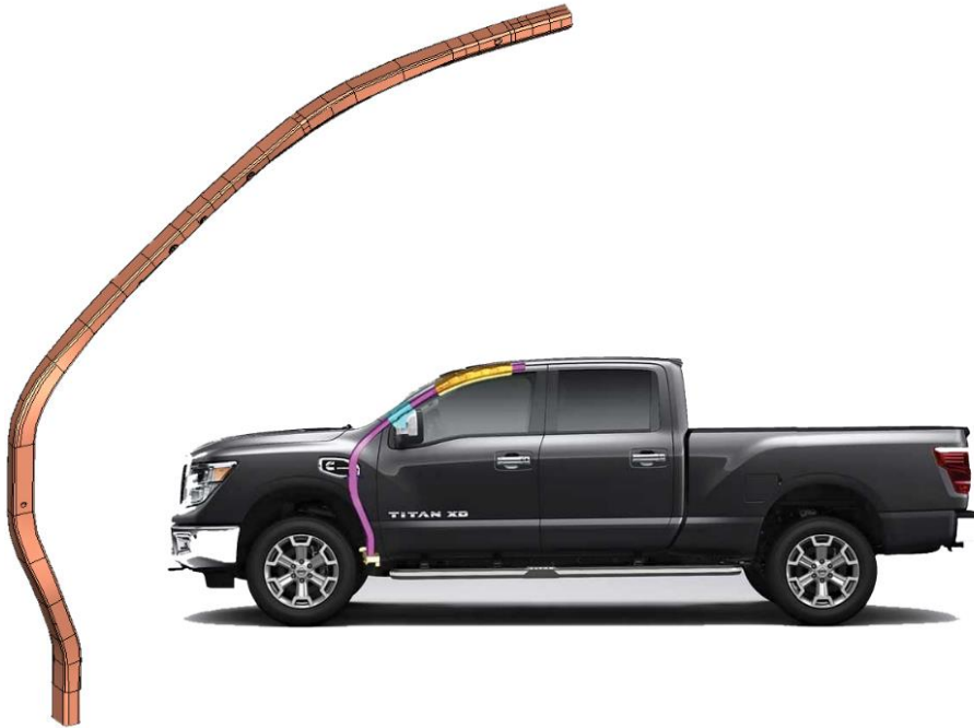
Ilustración 16. Ejemplo de barra hidroconformada en un Nissan Titan XD. (WorldAutoSteel, n.d.-d) (J. Tessmer et al., 2016)
