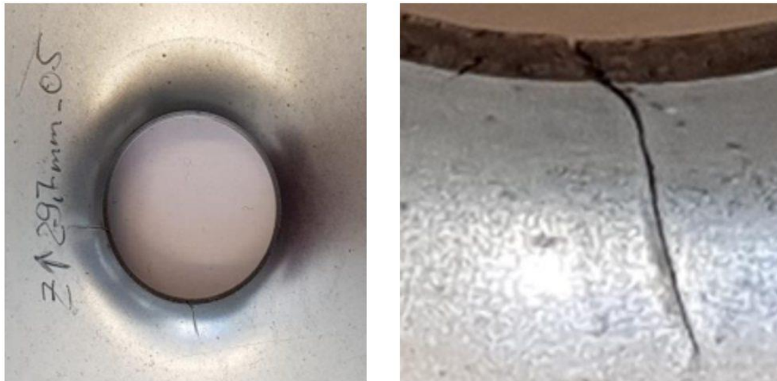
Ilustración 23. Ejemplo de fallo de material con fractura por insuficiente conformabilidad local. (WorldAutoSteel, n.d.-c)(Habibi et al., 2019)
