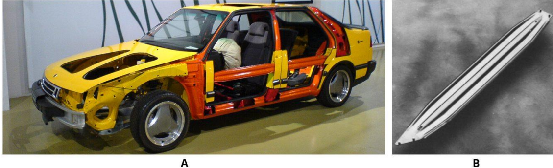
Ilustración 11. Saab 9000 comercializado entre 1984 y 1988 con detalle de la barra de protección lateral instalada. (Billur & WorldAutoSteel, n.d.)(Saab, n.d.)(Lagneborg, 1991)
