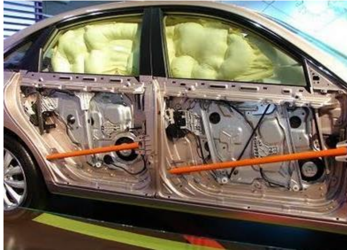
Ilustración 14. Integración de la barra de protección lateral en la estructura del vehículo Hyundai Azera. (WorldAutoSteel, n.d.-f) (Saraf & Bajaj, 2017)
