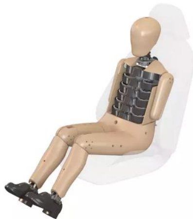
Ilustración 5. Dummy para colisión lateral WorldSID-5F.(Humanetics, n.d.-a)
