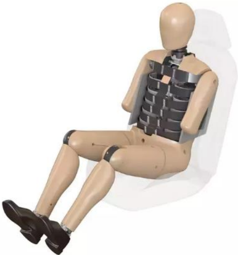
Ilustración 4. Dummy para colisión lateral WorldSID-50M. (Humanetics, n.d.-b)
