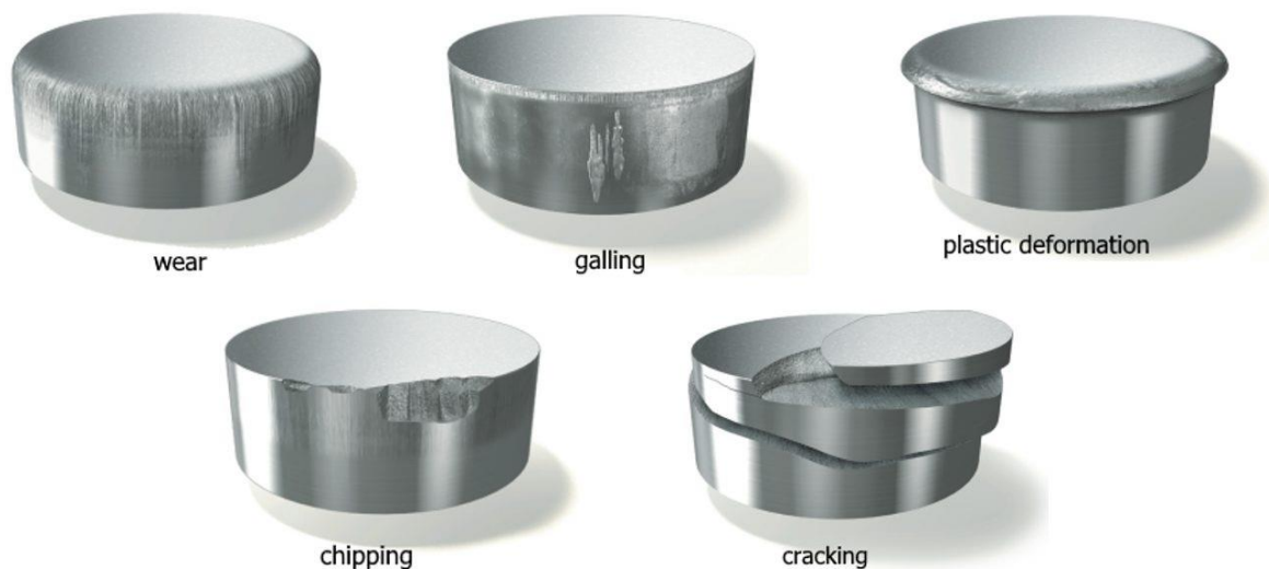
Ilustración 24. Fallos comunes en elementos de matricería y estampación de aceros. (WorldAutoSteel, n.d.-e)(Uddeholm AB, 2018)
