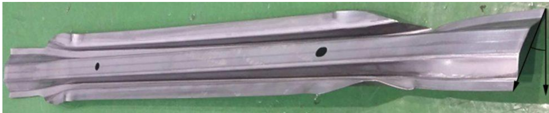
Ilustración 15. Barra de protección lateral fabricada por laminado y estampado. (D. Kim, 2015)
