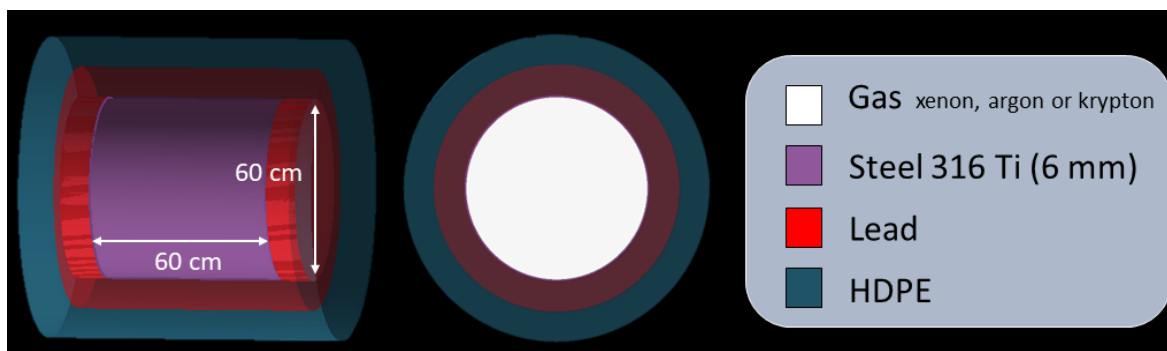
Figura 7.1: Dos perspectivas de la geometría del detector implementada en las simulaciones de GEANT4.
