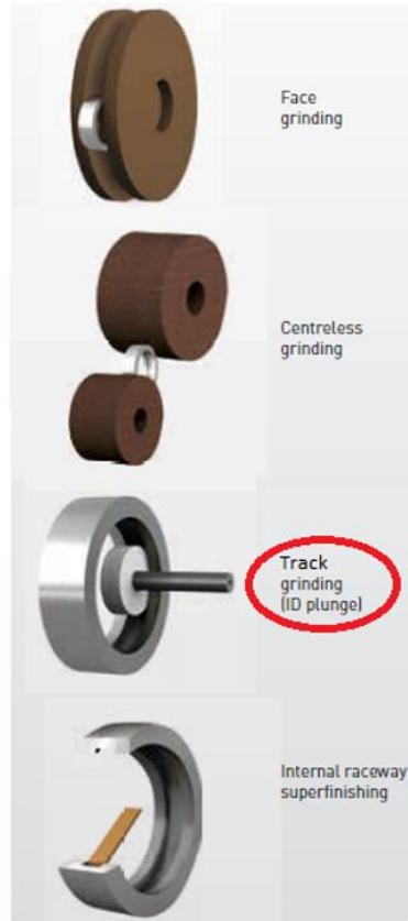
ILUSTRACIÓN 30 PROCESOS DE FABRICACIÓN DE AROS Y CONOS
