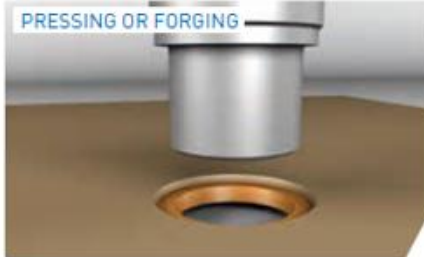
ILUSTRACIÓN 29 PROCESOS INICIALES DE FABRICACIÓN DE AROS Y CONOS
