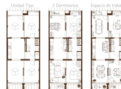
Fig. 48. Posibles tipos de distribución, flexibilidad.
