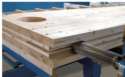
Fig. 36. Máquina de CNC cortando paneles de CLT a medida en fábrica.
