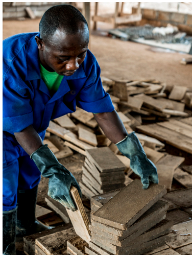
Fig. 15. Selección de tejas hechas a partir de tierra para el Rwanda Cricket Stadium
