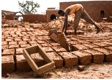
Fig. 14. Fabricación de ladrillos de adobe al estilo tradicional en Burkina Faso.
