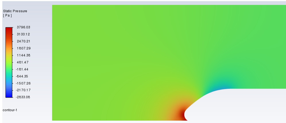
Figura 4.10: Perfil de la distribución de presión del flujo de aire alrededor del modelo 2 EUROLINK.
