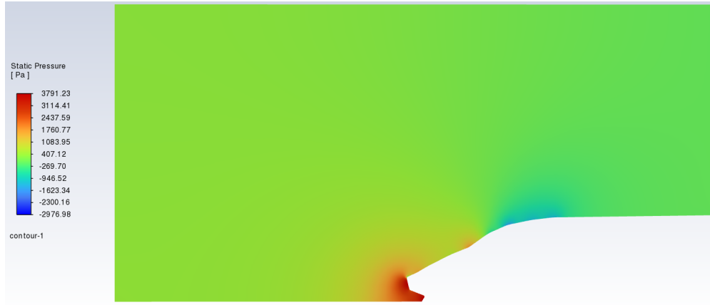
Figura 4.7: Perfil de la distribución de presión del flujo de aire alrededor del modelo 1 base de tren.
