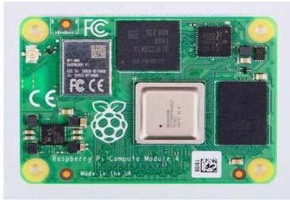
Figura 2. Referencia visual de la Raspberry Pi utilizada (Compute module 4)
