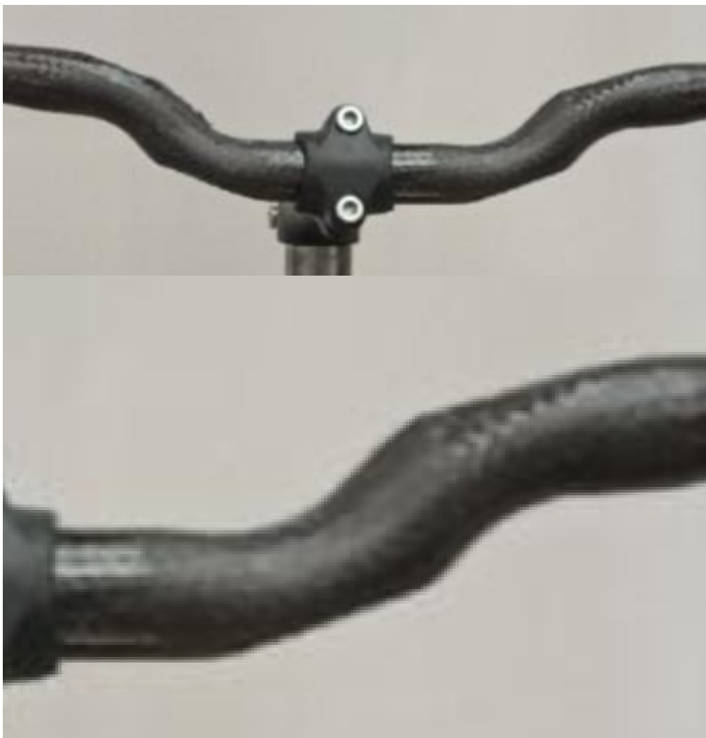
Figura 8.2. Detalle del fallo de fabricación
