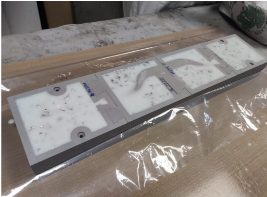
Figura 5.4. Capa protectora de resina epoxi
