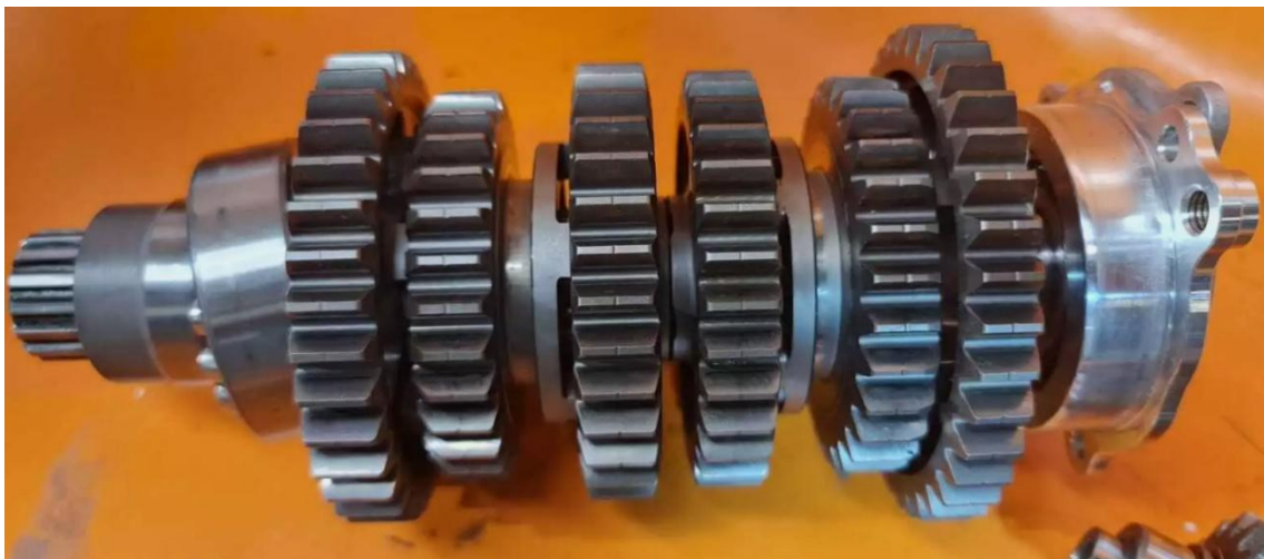
Figura 12: Eje secundario de salida
