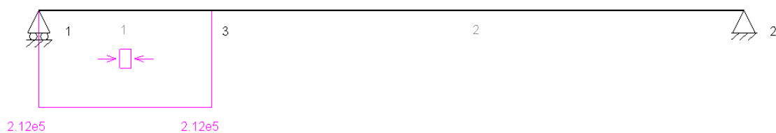
Figura 88: Esfuerzo cortante en XY radial
