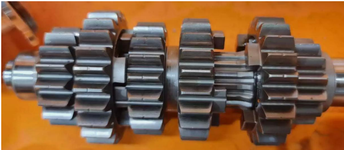
Figura 11: Eje primario de entrada
