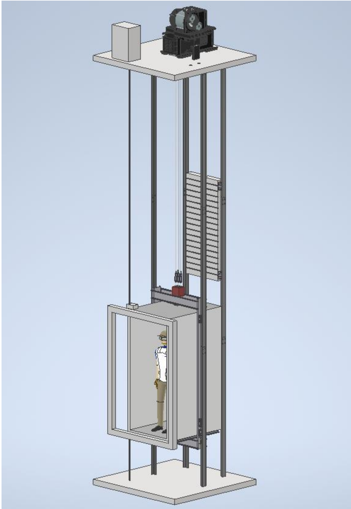
Ilustración 15- Instalación de ascensor con paracaídas electromecánico y limitador electrónico. Fuente: Elaboración propia.
