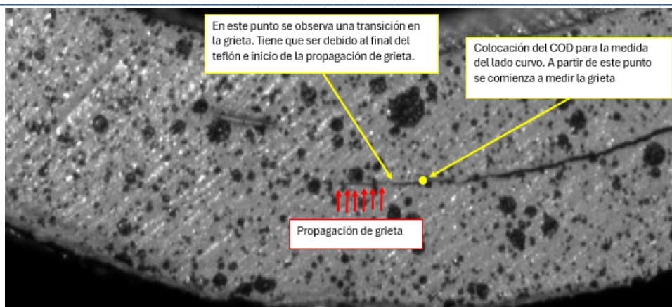
Figura 32. Inicio propagación grieta parte curva Prueba experimental 2.
