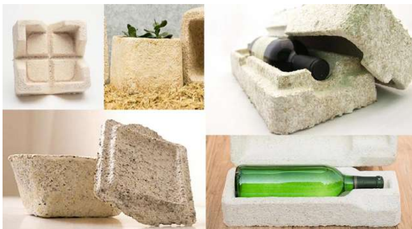
Figura 3.1: Espuma de material a base de micelio utilizado para embalaje.
