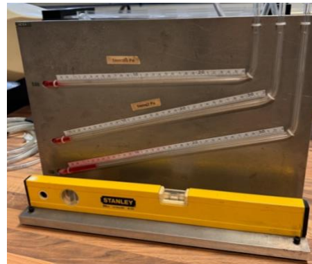
Ilustración 3. Sistema de medición de presión del Tubo de Pitot. Relación de 1 mm equivalente a 2 Pa.
