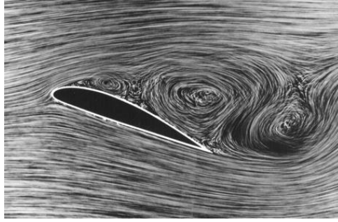
Figura 14. Observación del desprendimiento de vórtices a grandes ángulos de ataque [24].
