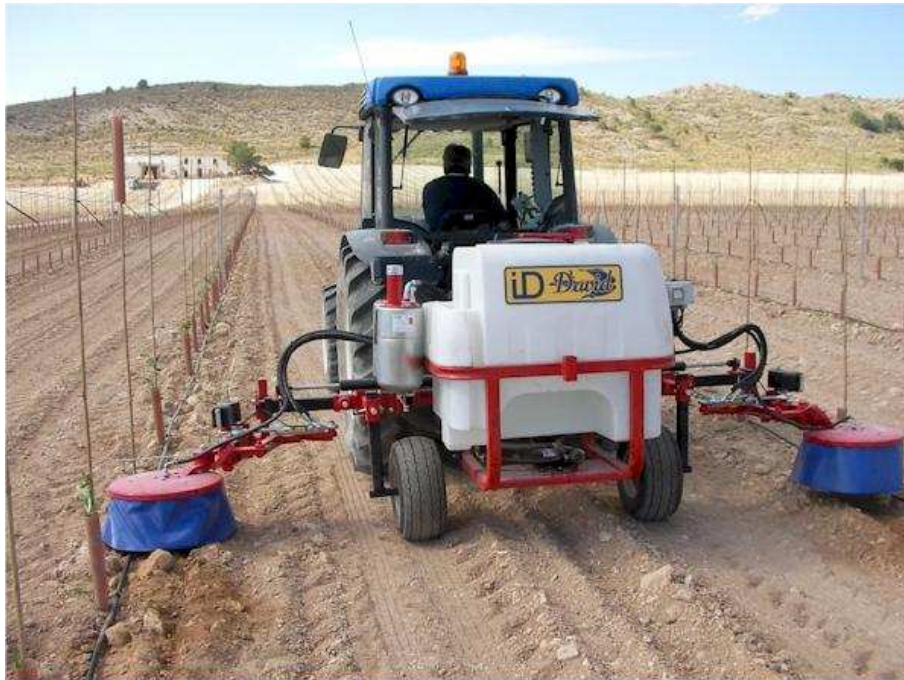
Ilustración 129. Tractor aplicando herbicida en la "tira"
