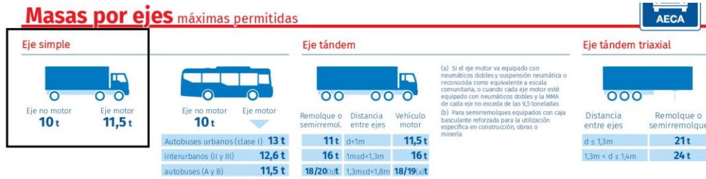
Ilustración 39 – Masas máximas autorizadas por ejes en función del tipo de eje
