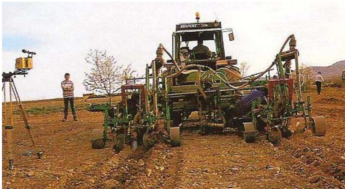
Imagen 8: Alineación con láser y plantación mecanizada. Fuente: Isiegas, J. R.
