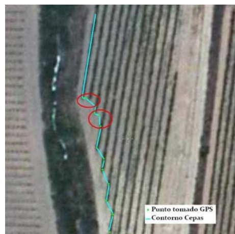
Imagen 3: Delimitación incorrecta, punto tomado fuera de cepa, creando una superficie que no corresponde con el uso viñedo. Fuente: Elaboración Propia.
