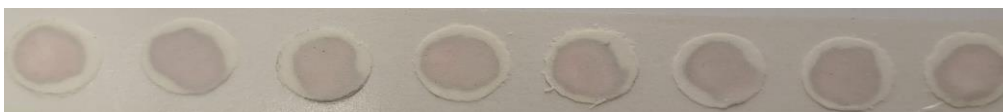
Figura 30: Imagen digital de la reacción de X/XO, y detección colorimétrica con formación de AuNP's en experiencia SIN metanol. Imagen tomada a 6 min
