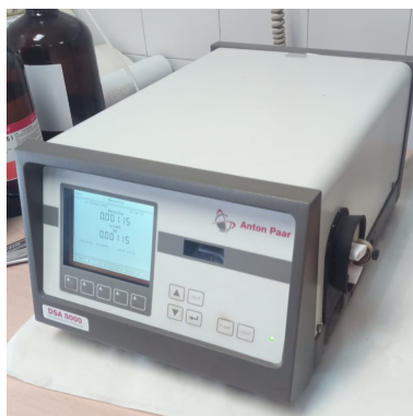
Figura 3: Analizador de densidades y velocidades del sonido Anton Paar DSA-5000
