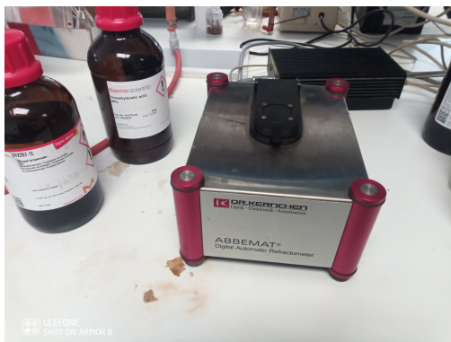
Figura 2: Refractómetro Abbemat HP
