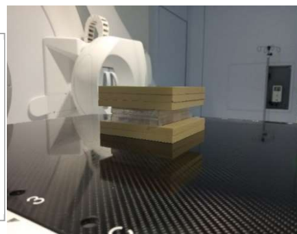
Figura 6: P24 colocada en la mesa de los pacientes de la máquina de radioterapia. La placa se encuentra entre las planchas de plástico para disminuir la incertidumbre de la radiación.
