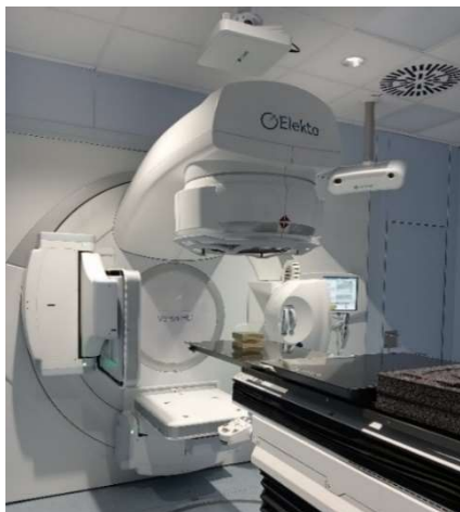
Figura 5: Acelerador Versa HD de Elekta. En negro a la derecha de la imagen se puede ver la camilla donde se tumba a los pacientes y, sobre ella, una placa de células preparada para el ensayo de irradiación (Zoom en la Figura 6).
