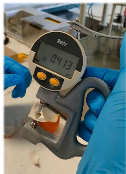
Figura 18. Micrómetro digital medidor del grosor de la cáscara.
