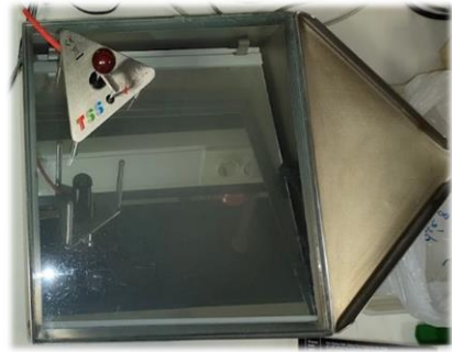
Figura 9. Micrómetro automático medidor de la altura del albumen sobre
