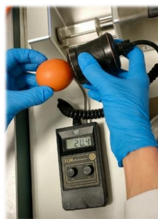
Figura 8. Medidor de color de cáscara por reflectometría.
