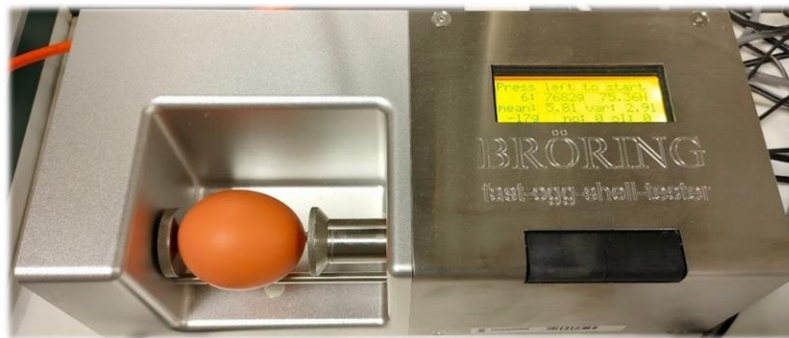
Figura 17. Medidor de la firmeza de la cáscara por resistencia a la rotura.
