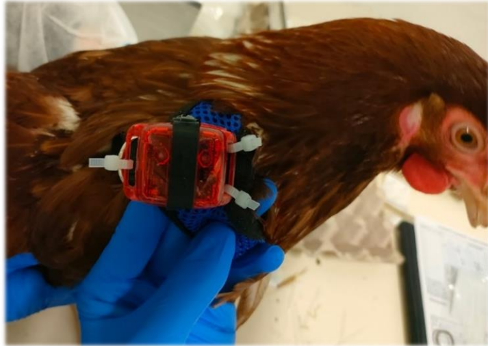
Figura 19. Acelerómetro colocado en el arnés.
