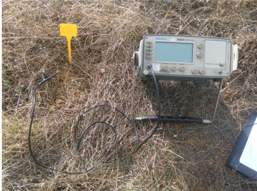
**Imagen 8:** *Muestreo de humedad del suelo utilizando el medidor TDR.*
