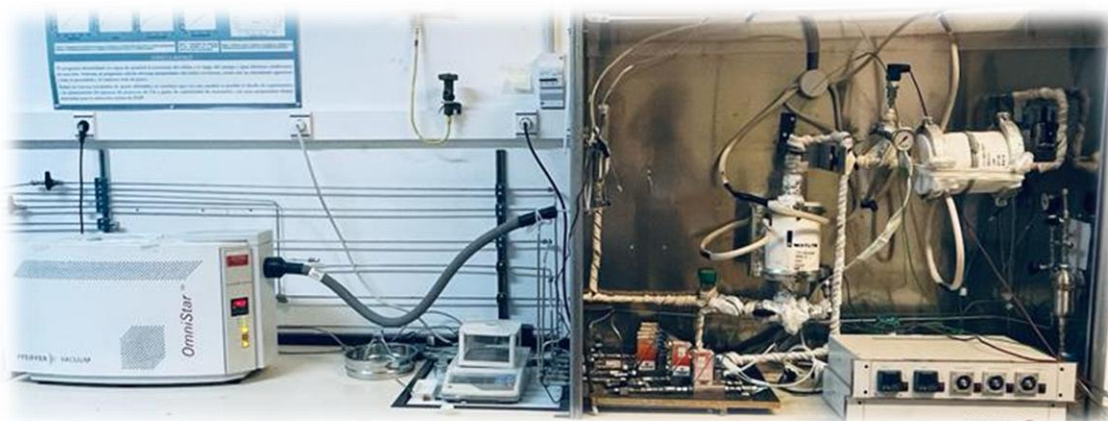
Figura 18: Esquema (arriba) y fotografía (abajo) de la instalación experimental de micro-reactor de lecho fijo utilizado en este trabajo
