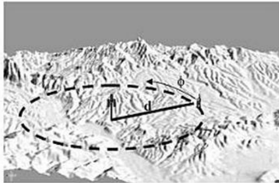
Figura III.1 Terminal móvil girando alrededor de una antena omnidireccional.
