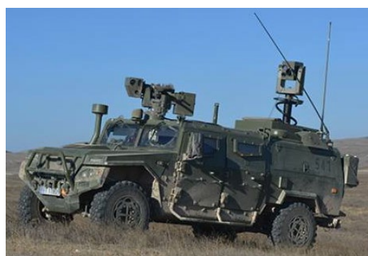
Ilustración 2. Vehículo de exploración y reconocimiento terrestre (VERT) sobre VAMTAC. (Fuente: ejercito.defensa.gob.es)
