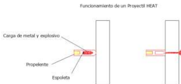
Ilustración 6: funcionamiento de un proyectil HEAT. Fuente: World of Armor (2016).
