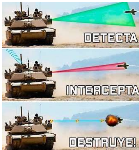
Ilustración 10: Funcionamiento de los sistemas APS. Fuente: el autor.
