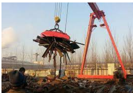
Figura 14. Imagen de un electroimán, extraída de http://j-magnetics.com/product/ES/MW5-Electroim--n-de-elevaci--n-para-chatarra-de-acero.html
