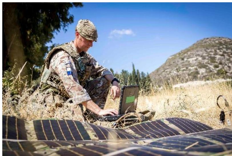
*Figura 7: Soldado del Reino Unido cargando su portátil con un cargador solar.*
