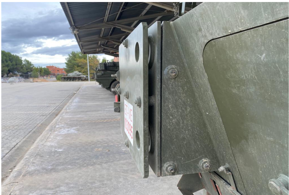
Ilustración 32. Refuerzo de protección de portón de baterías. Parte trasera del vehículo. Fuente: elaboración propia.
