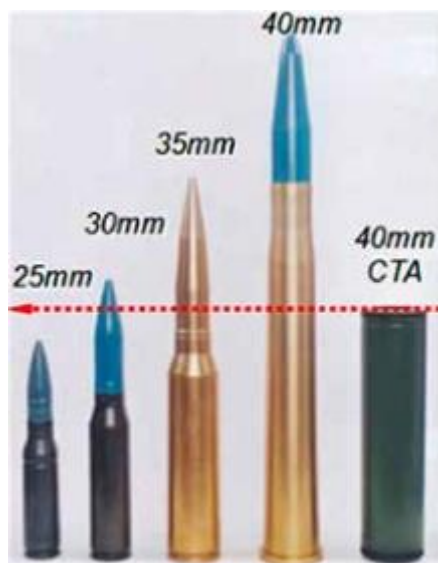
Ilustración 3. Comparativa de municiones convencionales con munición telescópica. Fuente: Memorial de Caballería 88.
