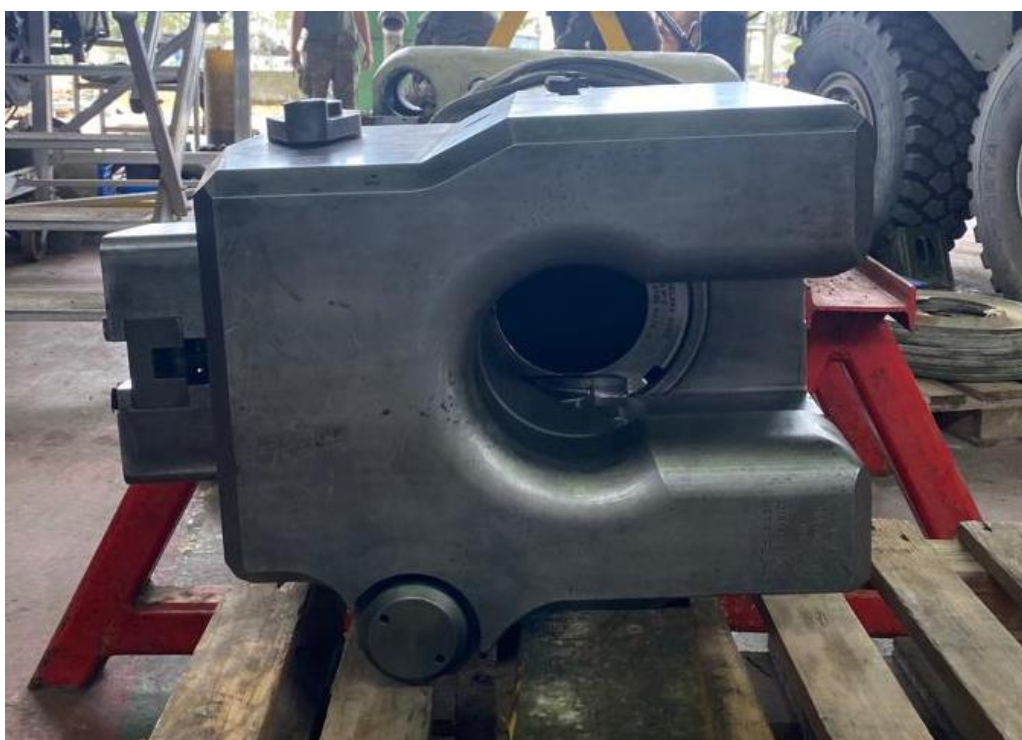
Ilustración 25. Recámara del cañón Oto Melara 105 mm. Segundo escalón de mantenimiento. Fuente: elaboración propia.
