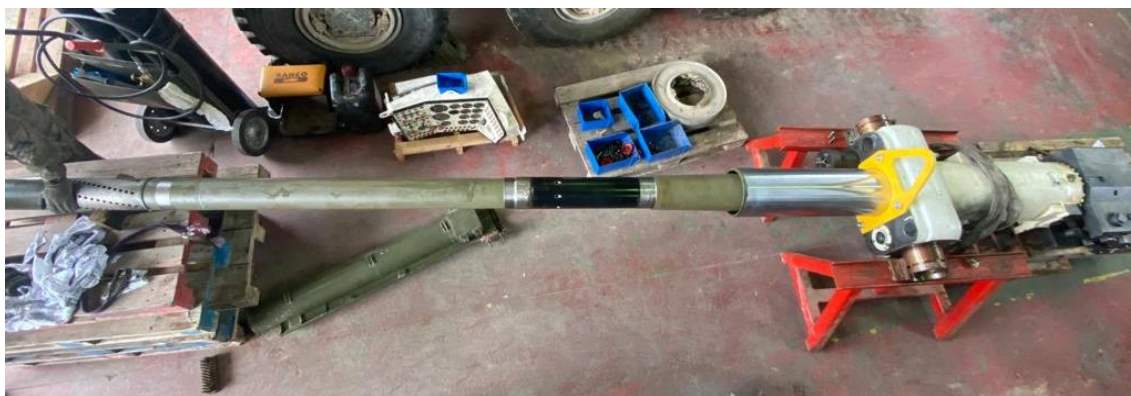
Ilustración 24. Planta del cañón Oto Melara 105 mm del vehículo. Segundo escalón de mantenimiento. Fuente: elaboración propia.
