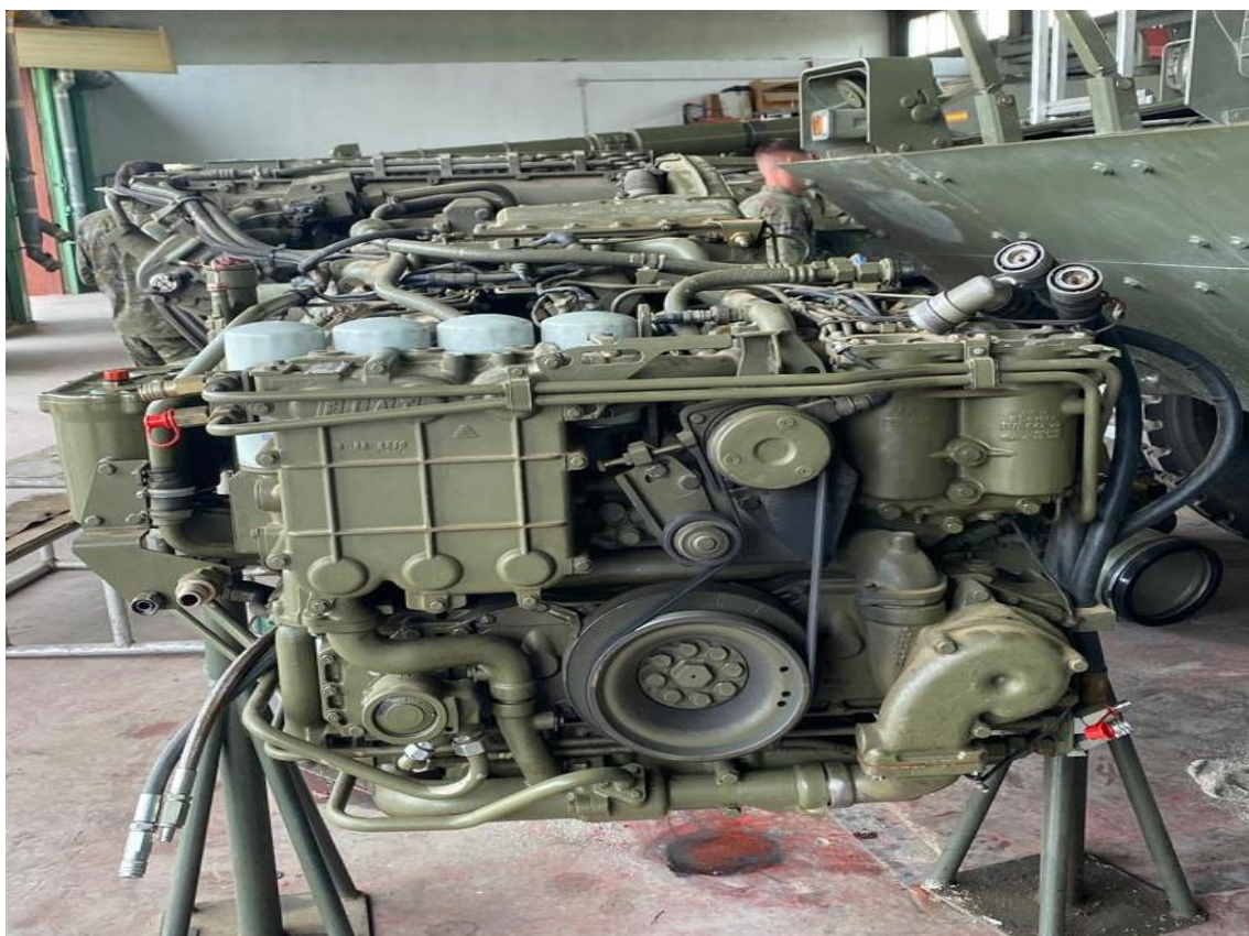
Ilustración 22. Parte lateral del motor de VRCC 'Centauro'. Segundo escalón de mantenimiento. Fuente: elaboración propia.
