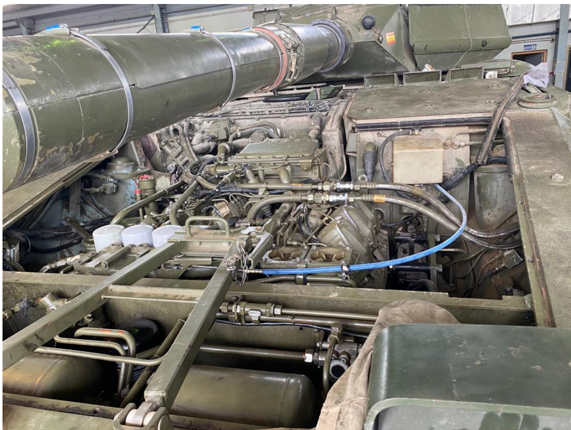
Ilustración 23. Tapa motor de la plataforma VRCC 'Centauro'. Segundo escalón de mantenimiento. Fuente: elaboración propia.
