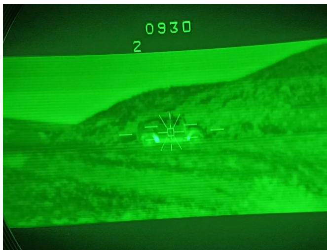
Ilustración 18. Vehículo VAMTAC visualizado por la cámara térmica del VCI Pizarro en campo estrecho. Fuente: Elaboración propia
