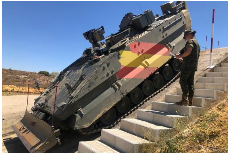
Ilustración 20. Vehículo de zapadores Castor en pruebas (Ministerio de Defensa, 2019)
