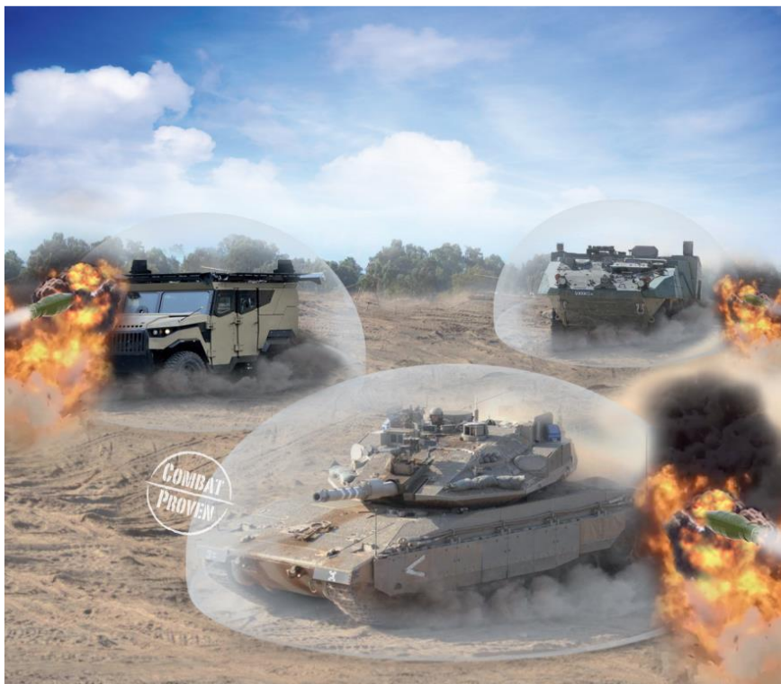
Figura 23: Funcionamiento APS Trophy. Cobertura 360° en 3 dimensiones. Fuente: Empresa Rafael
