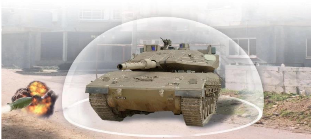
Figura 5: Concepto de protección de un APS. Fuente: Empresa Rafael
