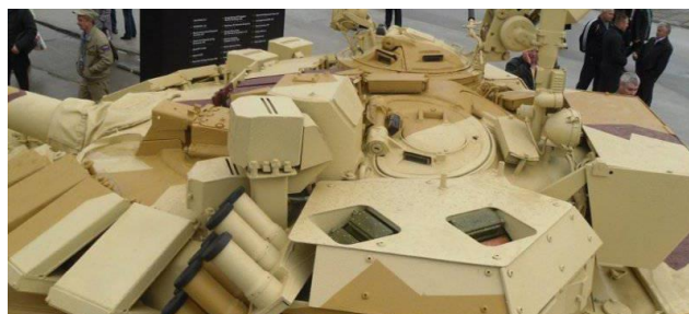
Figura 24: Sistema ARENA instalado en torre del T-72. Fuente: Análisis Militares
