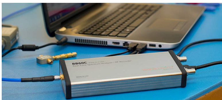
Figura 18: Receptor BB60C con sus componentes conectados [15].
