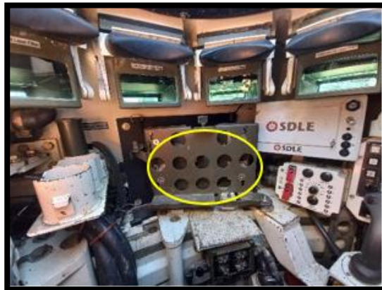
Figura 41: Ubicación del terminal del BMS en el puesto del jefe de vehículo. Fuente: Elaboración propia.
