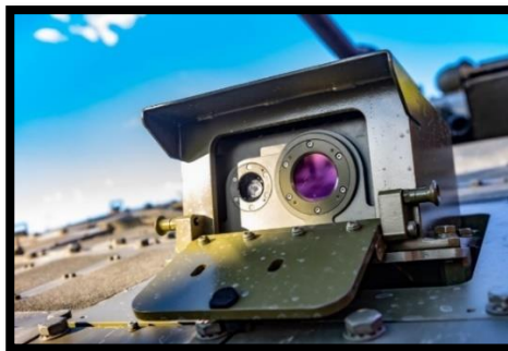
Figura 14: Cámara del sistema VTC-DUAL implementada en el glacis del VCI "Pizarro". Fuente: Página web de la empresa desarrolladora Escribano Mechanical and Engineering.
