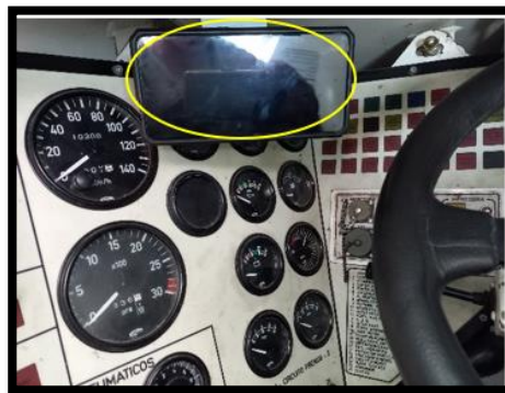
Figura 39: Ubicación óptima del monitor en la cámara de conducción. Fuente: Elaboración propia.
