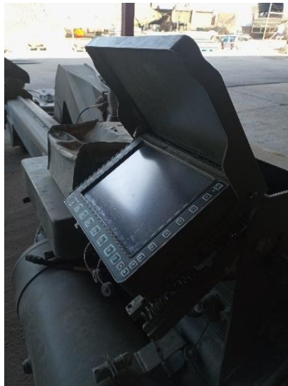
Figura 3: CDU integrada en el obús SIAC
