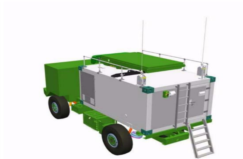
Figura 18. Contenedor acoplado a un camión todo terreno. Fuente (Saab, 2008)
