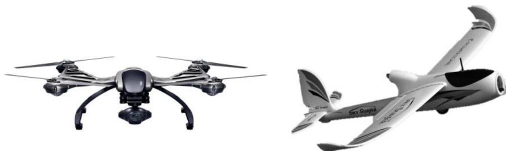
Figura 2. Drones (izquierda) ala rotatoria, (derecha) ala fija (Pino, 2019).
