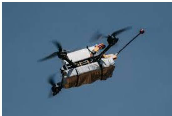
Figura 2: dron comercial adaptado para transportar explosivos (ECFA, 2023)
