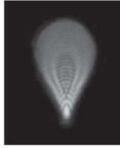
Figura 5 Imagen que proporciona un sistema con aberración de coma para un objeto puntual. 1
