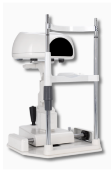
Figura 2. Topógrafo corneo-escleral llamado SMap3D (14).
