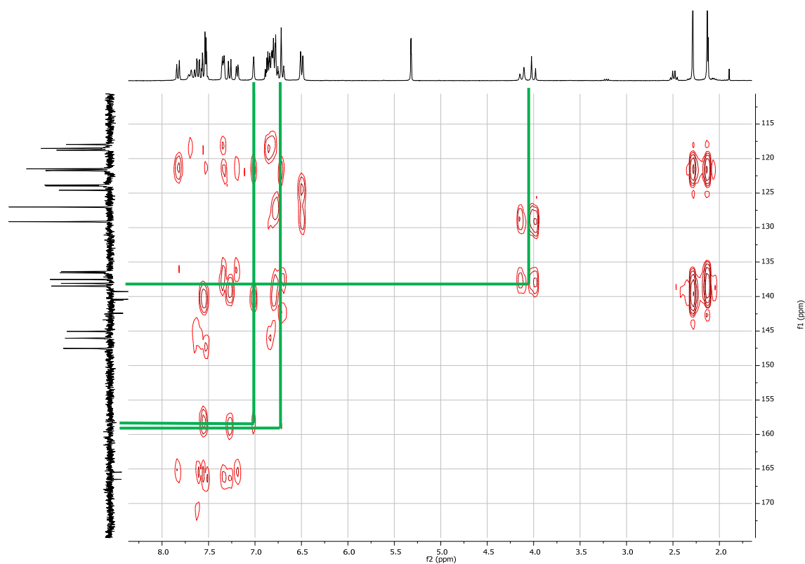
Figura AI.23. Espectro RMN de HMBC ^1\text{H} - ^{13}\text{C}\{^1\text{H}\} (75 MHz, \text{CD}_2\text{Cl}_2 , 298 K) del complejo 12.
