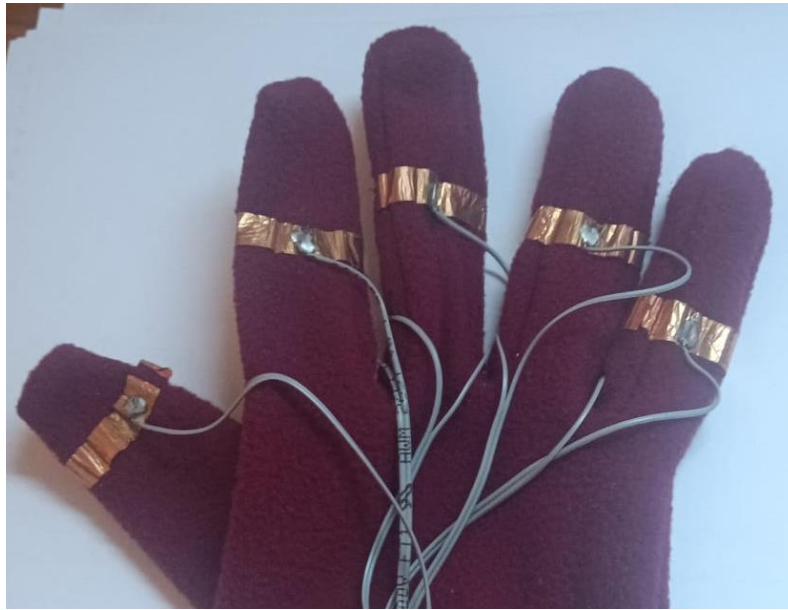
Ilustración 14: Guante con soldaduras finalizadas
