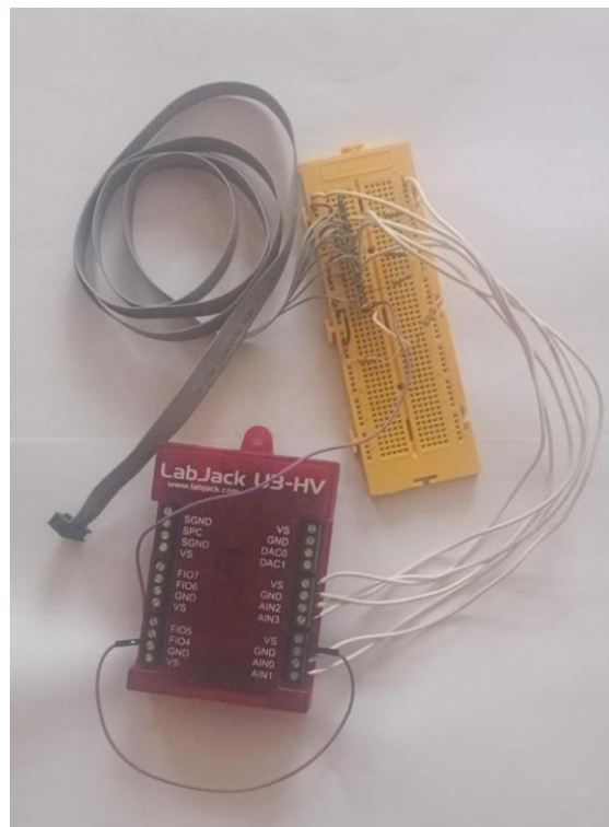
Ilustración 20: Circuito con conexión y tarjeta de adquisición de datos
