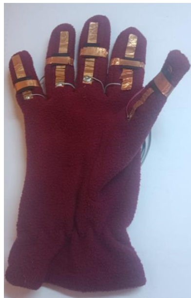
Ilustración 13: Palma del guante con soldadura de cables
