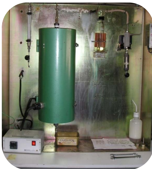
Figura 2.6. Planta donde se lleva a cabo la pirólisis.
