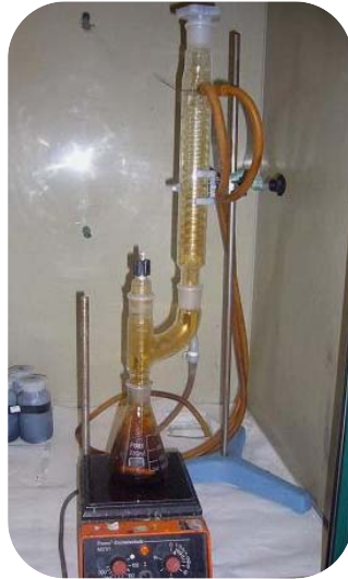
Figura 2.8 . Montaje oxidación en fase líquida.
