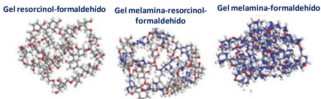
Figura 4.14. Representación esquemática de los posibles geles que pueden formarse entre resorcinol-melamina y formaldehído [Zhou, 2013].
