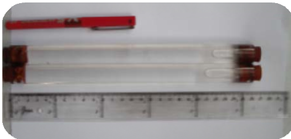
Figura 2.3 . Viales en los que se lleva a cabo la gelificación y curado de los geles orgánicos.
