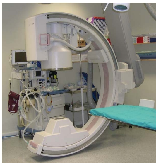
Figura 27. Angiógrafo Philips Integris 3000
