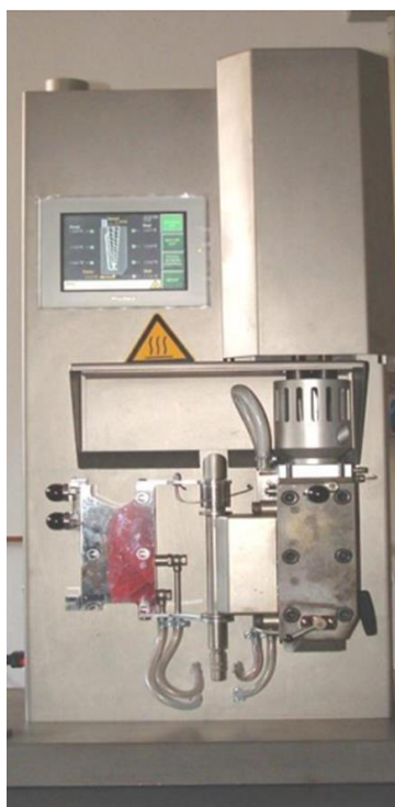
Figura 3.2. Imagen de la extrusora DSM Xplore 5&15 Micro Compounder 2005 utilizada para la preparación del material compuesto formado por UZAR-S1 y polisulfona Udel®.
