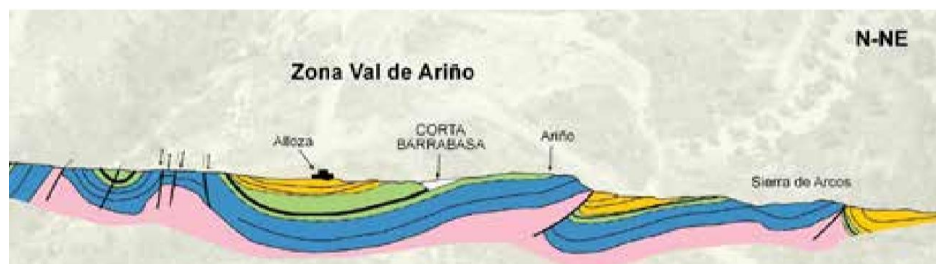
Figura 5. Corte geológico de la Val de Ariño. Fuente: (Hermosilla et al., 2017).
