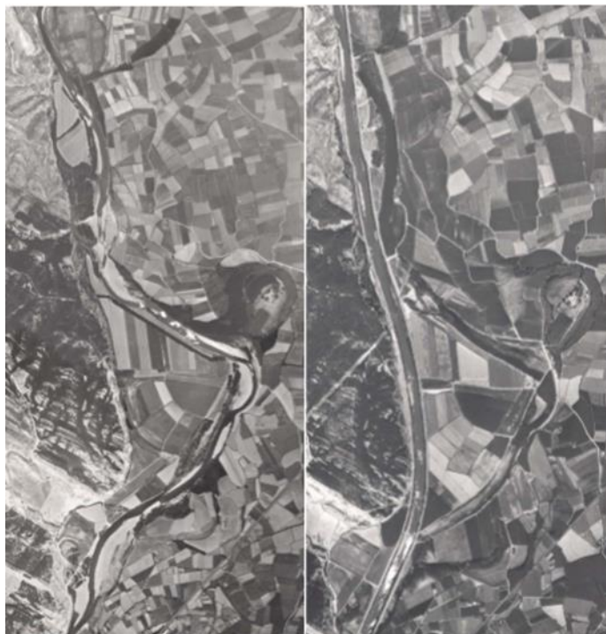
Figura 27. Río Arga antes de su canalización en 1982, y en 1992 posterior a la canalización. Fuente. (Ollero et al., 2007).
