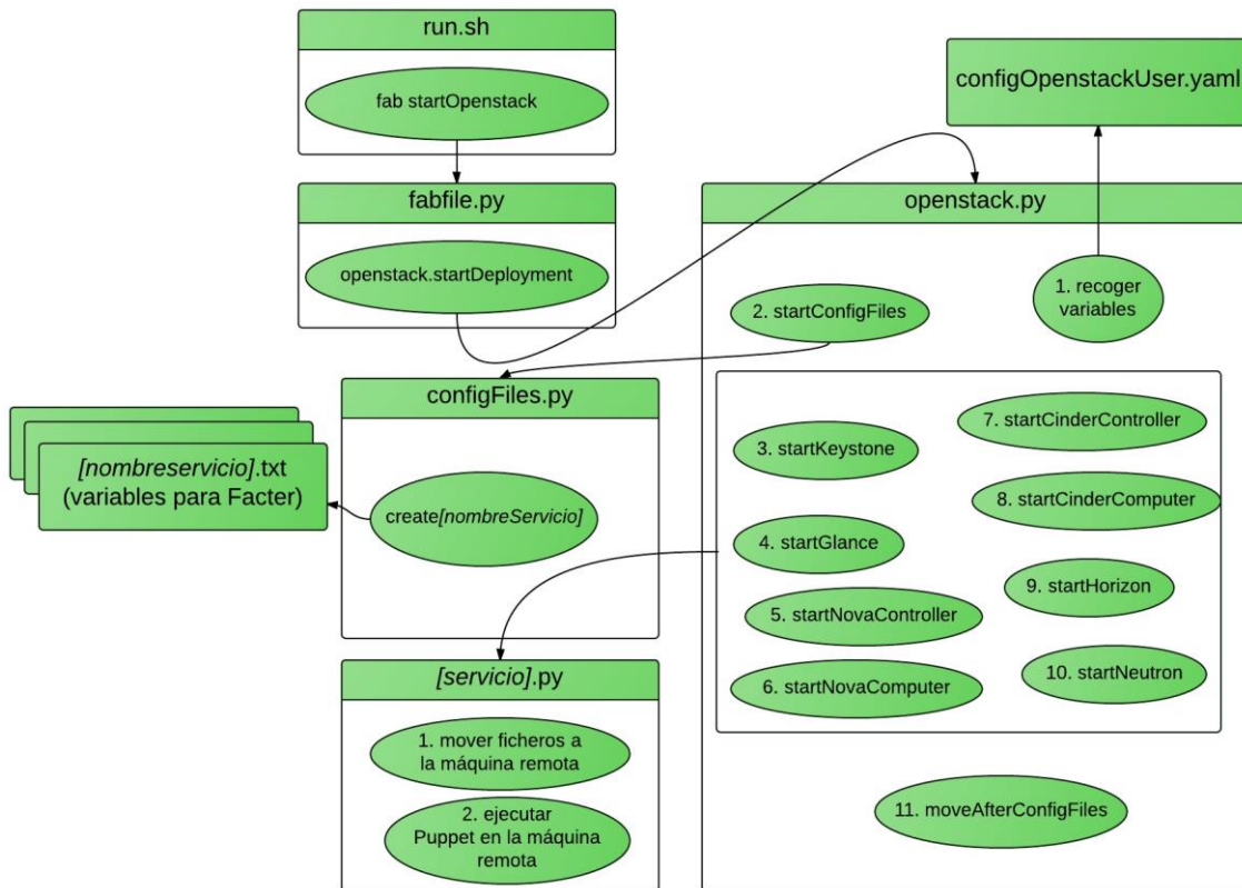
Figura 9: Flujo despliegue detallado
