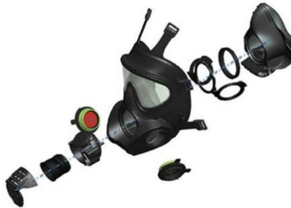
Ilustración 8. Despiece de la máscara. Fuente: Scott Safety.
